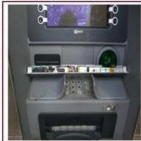
ВИДЕОКАМЕРА ДЛЯ ЧТЕНИЯ ПИН-КОДА
